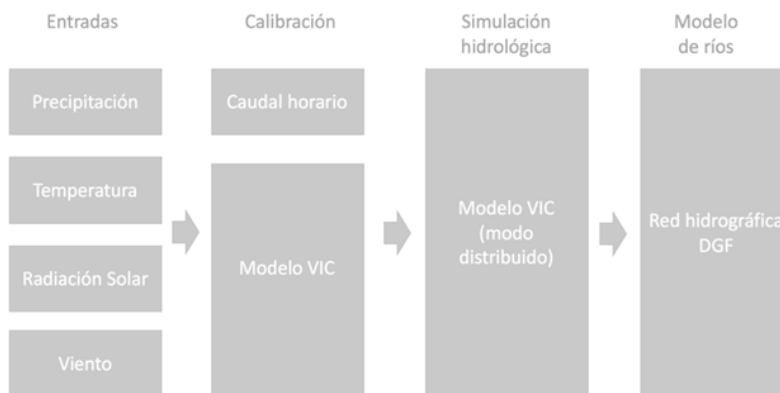
Figura 2 Flujo de trabajo del modelo VIC dentro de la Plataforma de Modelación para la Evaluación del Potencial Hidroeléctrico
